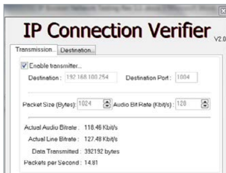
Illustration d'un outil de test de bande passante UDP sur la liaison
